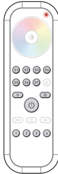
Bei Anschluss von **einfarbigen Leuchten** sind das RGB-Farbrad, der RGB-Sättigungsschalter, die Warmweiss-Taste, die Tuneable White-Taste sowie die Kaltweiß-Taste ohne Funktion!
