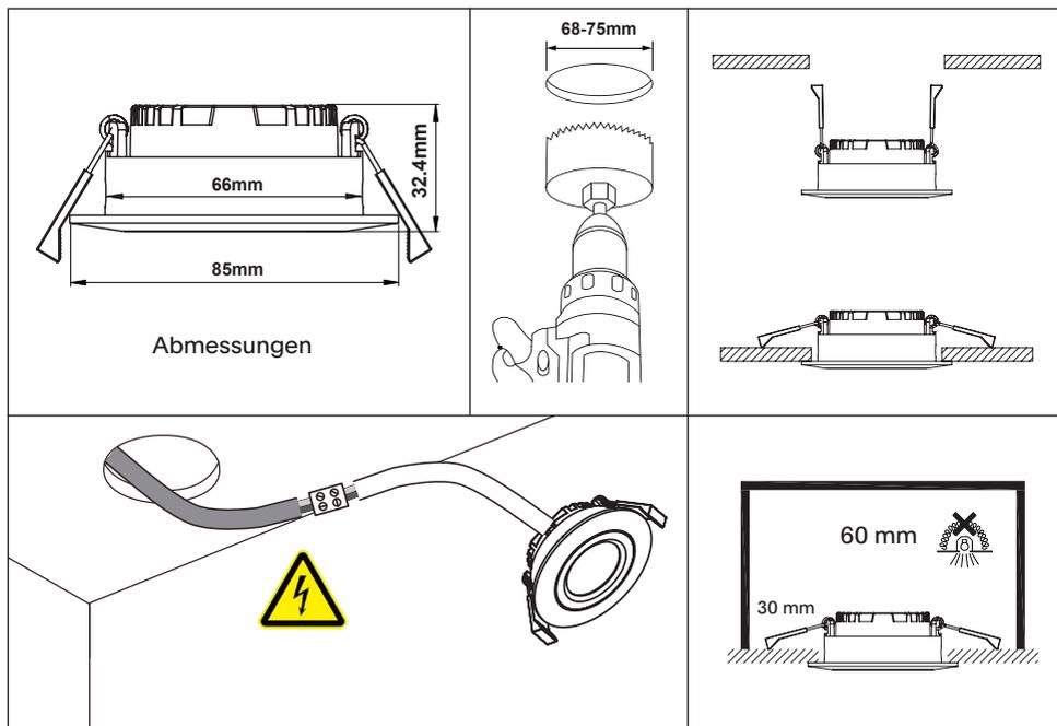
1. Die Leuchte auspacken und am Montageort einen geeigneten Deckenausschnitt  $\varnothing$  68-75 mm erstellen.
