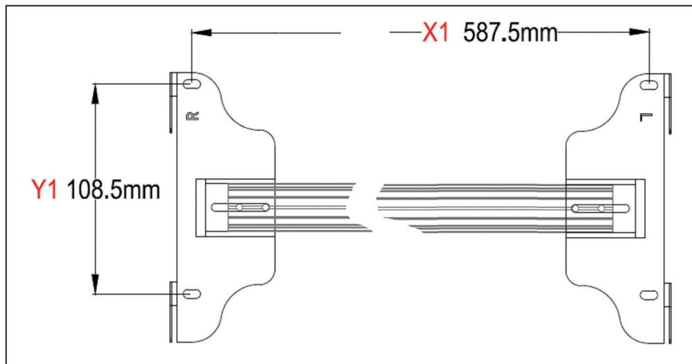
1. Die Leuchte auspacken und die Montage-schiene mit dem dafür geeigneten Befestigungsmaterial am Montageort befestigen. Den LED-Treiber an der Steckverbindung vom Panel trennen.
